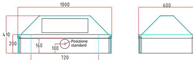
E' possibile ordinare flange di vari diametri e posizioni, a richiesta, inviando un disegno quotato.
