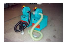
SALDEPUR AP: gruppo per aspirazione, filtrazione differenziata ed adsorbimento fumi, con una portata di 500 m3/h e motore da kW 0,37 con 13 Kg di carbone attivato speciale tipo C3. La foto illustra due gruppi: uno corredato di tubo flessibile antistatico nero ø 80 mm; l'altro con tubo flessibile PVC verde ø 80 mm e una cappa tipo CCM in lamiera zincata con magnete di fissaggio su superfici metalliche.
